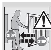
Initiez toutes les personnes utilisant l'installation de portail à sa commande correcte et fiable. Faites-leur une démonstration et un test du déverrouillage mécanique, ainsi que du rappel automatique de sécurité. Pour cela, interrompez la fermeture du portail en l'arrêtant avec vos deux mains. L'installation de portail doit amorcer le rappel automatique de sécurité.
