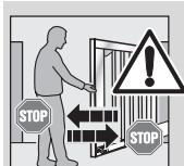
Weisen Sie alle Personen, die die Toranlage benutzen, in die ordnungsgemäße und sichere Bedienung ein. Demonstrieren und testen Sie die mechanische Entriegelung sowie den Sicherheitsrücklauf. Halten Sie dazu das Tor während des Torszulaufes mit beiden Händen an. Die Toranlage muss den Sicherheitsrücklauf einleiten.
