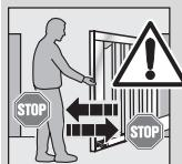
Instruya a todas las personas que utilizan la instalación de puerta sobre su manejo correcto y seguro. Ensaye y pruebe el desbloqueo mecánico, así como el retroceso de seguridad. Para ello detenga la puerta con ambas manos durante el movimiento de cierre. La instalación de puerta debe iniciar el retroceso de seguridad.
