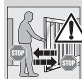
Werk iedereen, die de draaihekinstallatie gebruikt, in de voorgeschreven veilige bediening in. Demonstreer en test de mechanische ontgrendeling en de veiligheidsterugkeer. Hou daarvoor het draaihek tijdens de draaiheksluiting met beide handen vast. De draaihekinstallatie moet de veiligheidsterugkeer aanvatten.
