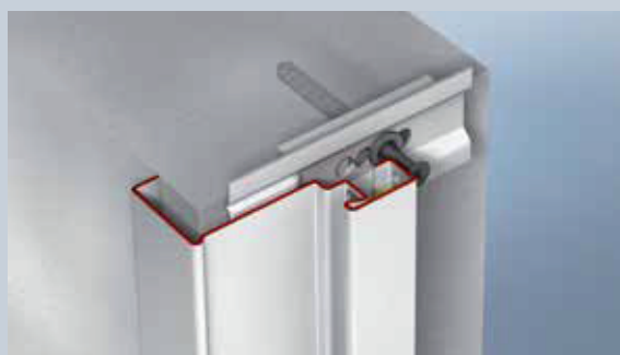
Atornillar el perfil de cerco angular 1 al tabique prefabricado
