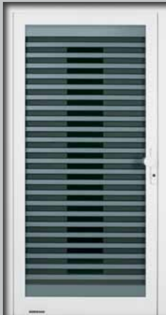
Modelo 100 / MG 113 Tirador estándar con pomo 54, acristalamiento de diseño en el exterior VSG con 25 bandas mateadas, Stopsol gris en el centro ESG con 26 bandas mateadas, VSG transparente en el interior, valor U_D de hasta aprox. 1,6 \text{ W}/(\text{m}^2\cdot\text{K})^*
