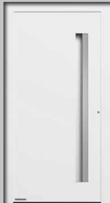
Modelo 309 Perfil tirador enrasado de serie en aluminio blanco RAL 9006, brillo sedoso, tirador encastrado de serie en el color de la puerta, puerta certificada para casa pasiva, valor U_D de hasta aprox. 0,51 \text{ W}/(\text{m}^2\cdot\text{K})^*
